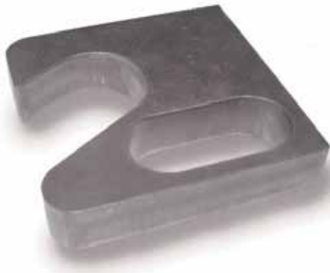
20毫米低碳钢切割样件
